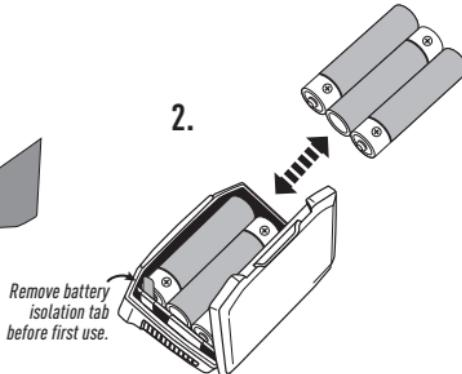
RETRIRER LA LANGUETTE ISOLANTE DES PILES AVANT LA PREMIÈRE UTILISATION.
